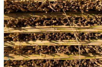
Ευρεία χρήση καλαμιών μείγματα ωμών πλίνθων και μπαγδατί
